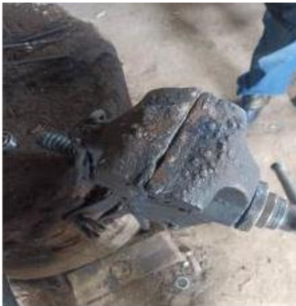
На стальных сменных плоских планках губок отсутствует насечка на рабочей поверхности для прочного захватывания зажимного изделия.
