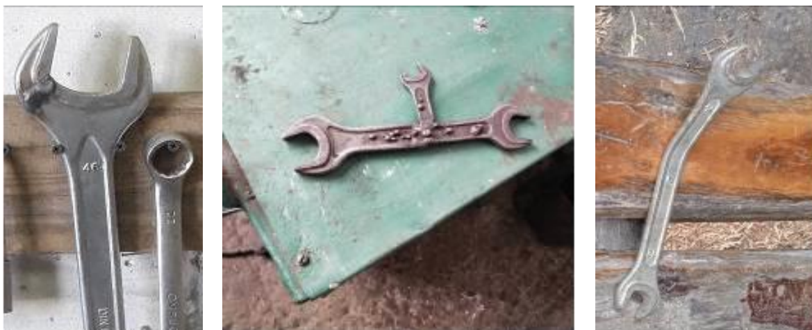
Гаечные ключи соединены при помощи сварки, деформированы.
