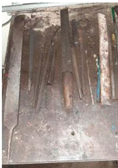
Напильники не имеют рукояток, режущий инструмент самодельного изготовления.
