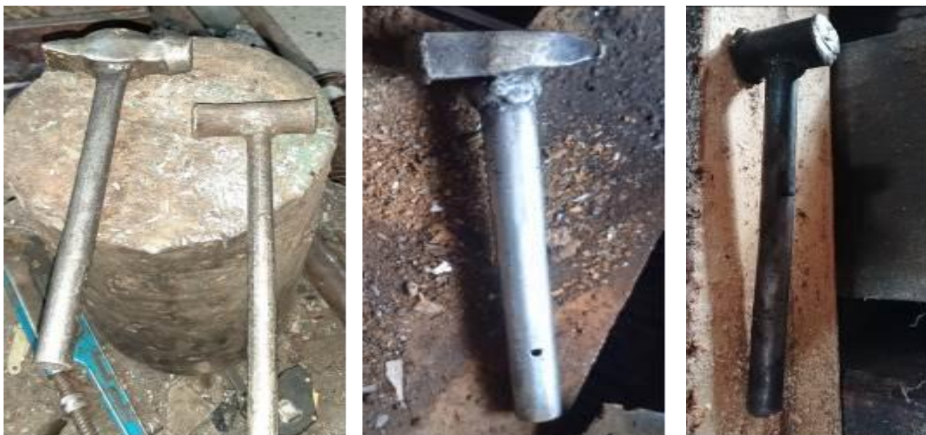
Рукоятки молотков, кувалд изготовлены из металла, на поверхностях бойков имеются наклепы, заусенцы.
