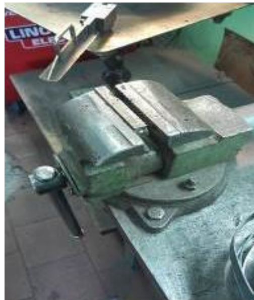
На стальных сменных плоских планках губок отсутствует насечка на рабочей поверхности для прочного захватывания зажимного изделия.
