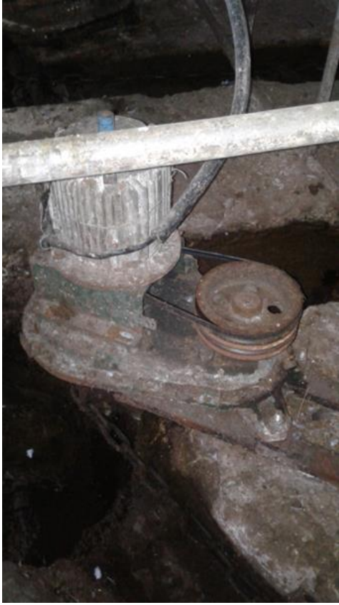
Не ограждена ременная передача системы навозоудаления
