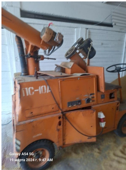
Отсутствуют защитные ограждения на ременных и цепных передачах протравителя семян ПС 10
