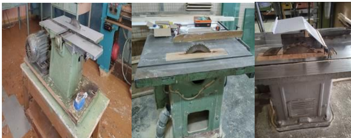
Защитное устройство режущего органа отсутствует или самодельное, расстояние между режущим органом и расклинивающим ножом более 10 мм (отсутствует расклинивающий нож).
