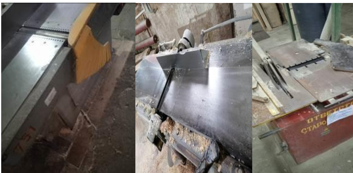
Отсутствует (неисправное, самодельное) веерное ограждение деревообрабатывающего станка
